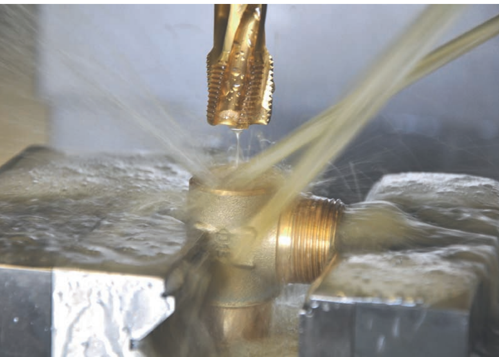
1 Gewindefertigung in einer Trinkwasser-Armatur aus bleifreiem Messing CuZn38As auf einem Bearbeitungszentrum mit einem neu entwickelten Werkzeug
